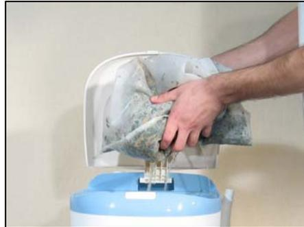
**5)** Danach hängen Sie den Abfuhrschlauch wieder zurück. Entfernen Sie nun den Reinigungssack (mit eventuellem Blattabfall) und danach den Auffangsack. Tauchen Sie den Sack 3 oder 4 mal ins Wasser, damit sich die Kristalle in der Mitte sammeln. Pressen Sie nun mit der Hand das Wasser heraus und danach mit dem Küchenpapier.
